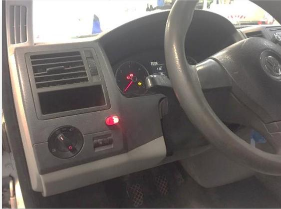
Schalter gut sichtbar im Armaturenbrett anbringen. Massepunkt des Schalters herstellen und die 2 weiteren Kabel nach vorn Richtung Relais verlegen.
