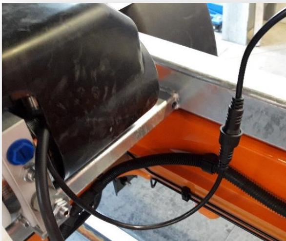
Alle Kabel werden nach Ihrer ordnungsgemäßen Verlegung zusammen mit Kabelbinder unter Beachtung der Aufbauhersteller-richtlinie befestigt. Bitte befestigen Sie dieses Kabel erst nachdem Sie die restlichen Kabel verlegt und angeschlossen haben.
