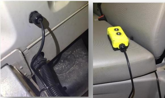
4. Im nächsten Schritt Lösen Sie die Verbindung der Fernbedienung vom Kabelbaum.
