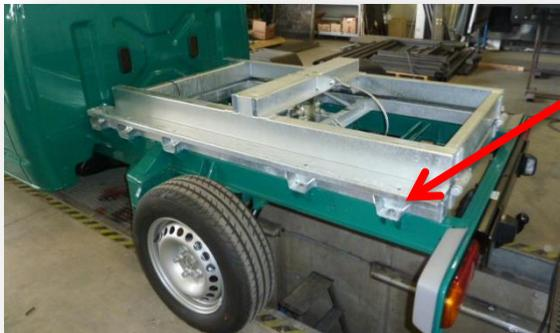
2. Montage des Zwischenrahmens auf das Fahrgestell.
