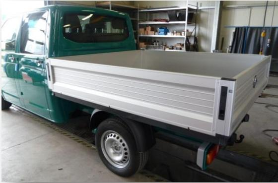
1. Demontage der Werkspritsche inkl. Kotflügel vom Fahrgestellrahmen.
