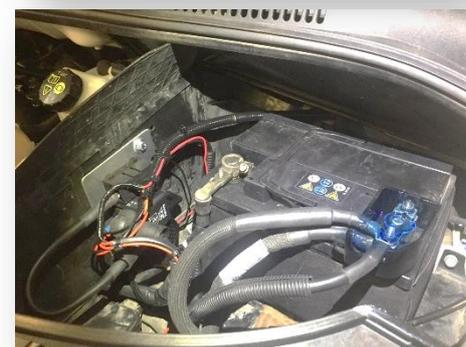
5. Die am vormontierten Hydraulikaggregat befestigten elektrischen Kabel müssen bis zu Fahrzeugbatterie vorgezogen werden.
