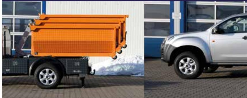
Das Ausschlaggebende für die verbleibende Nutzlast ist das Gewicht des Trägerfahrzeuges. Die verbleibende Nutzlast für einen aufgelasteten Isuzu D-Max mit Abrollgerät und einem stapelbaren Kunath Leichtbauabrollcontainer beträgt 1.020 kg. Diese Nutzlast kann auch für entsprechend leichte Transporter im 3,5 t zGG-Bereich abgebildet werden.
