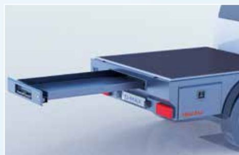
› Lastenauszug (B 740 mm x L 1.470 mm x H 85 mm)
