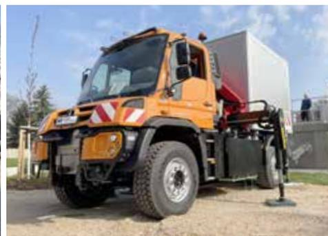
Verdichteraufbau für Hochwasserschutz
