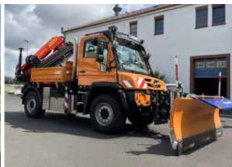
Zweiseitenkipper mit Palfingerkran (PK 14.502)
