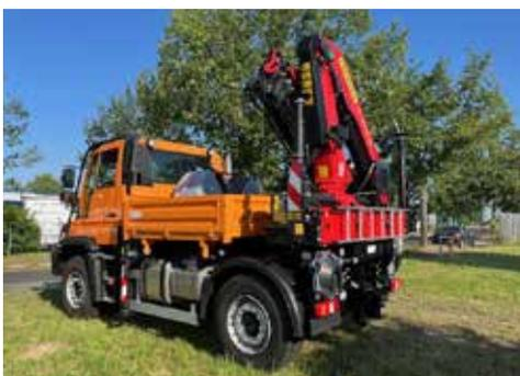
Zweiseitenkipper mit Palfingerkran (PK 14.502)
