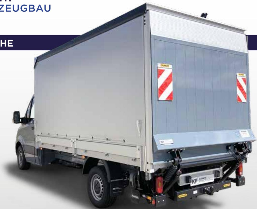
**Sprinter mit Pritsche, Plane- und Spriegelaufbau
