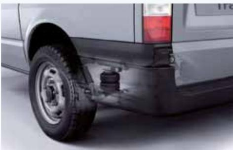
› Zusatzluftfederung für die Hinterachse
